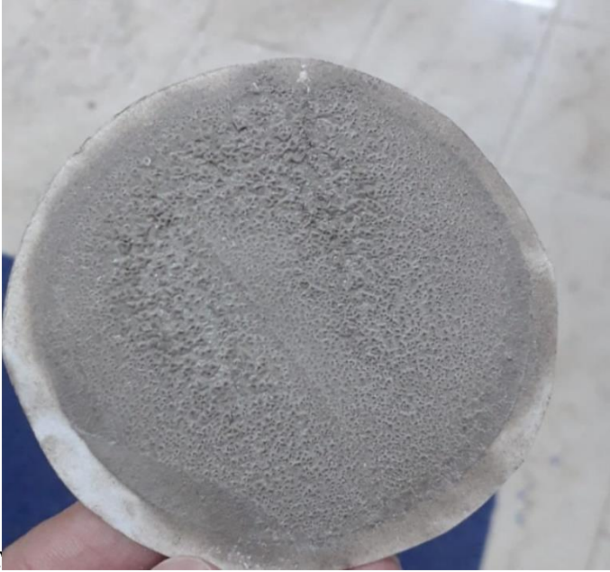
Şekil 15 .Fındıkkabuğu (2 g 0,125 mm) İlave Edilmiş Kcl Çamuru İle Elde Edilen Filtre Keki
