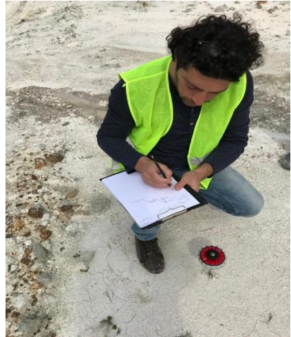
Şekil 5. Açık ocak alanında saha incelemeleri, örselenmemiş örnek alımı ve Vane deneyi.
