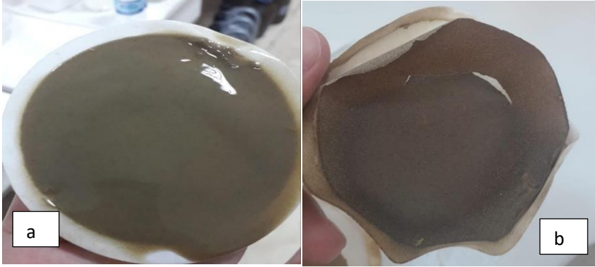
Şekil 12 . Siyah Çekirdek Kabuğu(2 g 0.125 mm) İlaveli Lignosülfonat Çamuru İle Elde Edilen Filtre Keki (a) Deney Sonrası, (b) Kuruduktan Sonra
