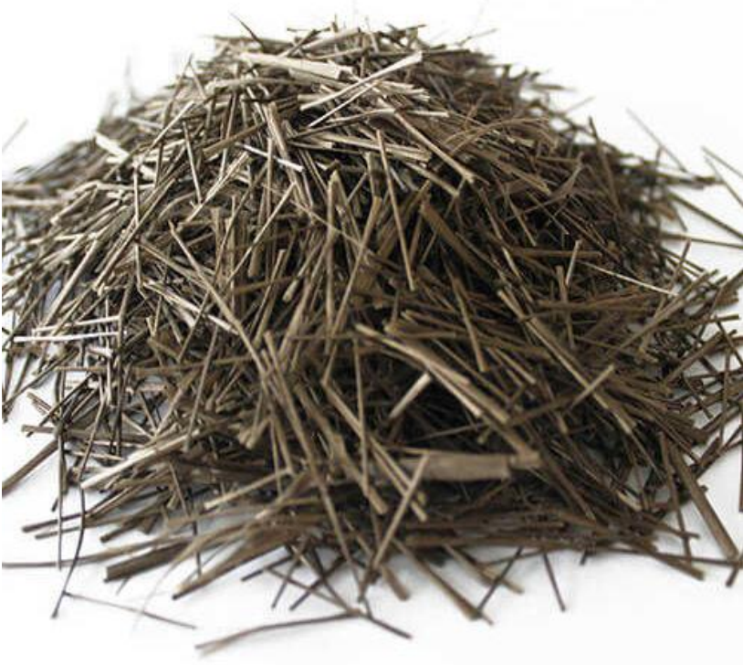
Şekil 1.2. 24 mm boyunda kırpılmış bazalt fiberin görüntüsü.
