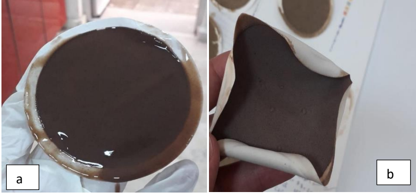
Şekil 14. Fındıkkabuğu (2 g 0,125 mm) Eklenmiş Lignosülfonat Çamuru İle Elde Edilen Filtre Keki (a) Deney Sonrası, (b) Kuruduktan Sonra
