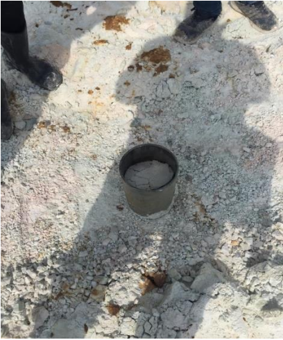
Şekil 5. Açık ocak alanında saha incelemeleri, örselenmemiş örnek alımı ve Vane deneyi.
