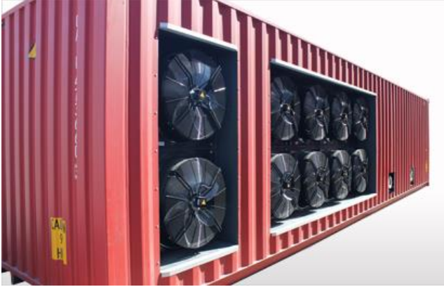
Şekil 1. Beton soğutma ünitesi.
