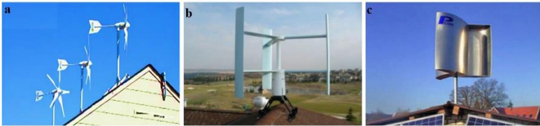
Şekil 2. a) YERT b) H-Darrieus DERT ve c) Savonius DERT’in saha gösterimi (Tanürün, 2023b)
