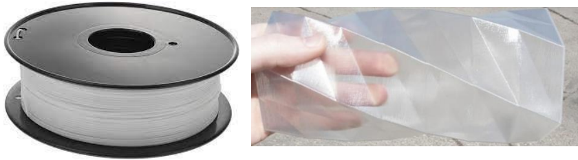
Şekil 7. PETG filamenti ve üretilen parça örneği
