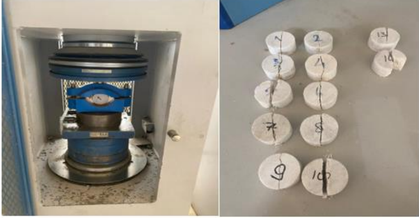
Şekil 7. Brazilian deneyine ait görüntüler a: Brazilian deneyinin uygulanması
