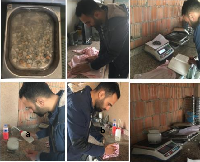
Şekil 10. Agreganın özgül ağırlık deneyinin yapılışına ait görüntüler. a: deneye tabii tutulan numuneler, b: yüzey kurulum işlemi, c: Kurulanan örneklerin tartılması, d: cam kavanozda numuneler, e: cam ile kapatılan numune kavanozu, f: cam kavanozla birlikte tartılan numuneler
