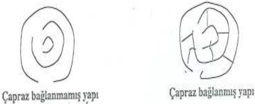
Şekil 3. Çapraz bağlanmamış ve bağlanmış polimer yapısı (Soyubol, 2006)
