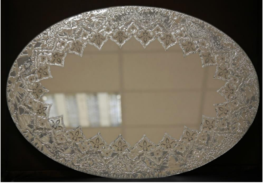
Resim 25. Döküm İşleminin Son Hali (92x64cm)-Cam Kalınlığı:6mm
