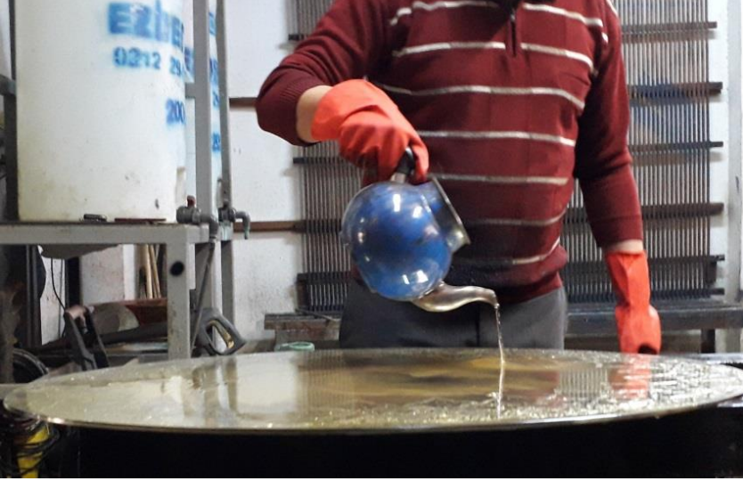
Resim.22. Geleneksel Yöntemlerle Ayna Sırrının Dökülmesi
