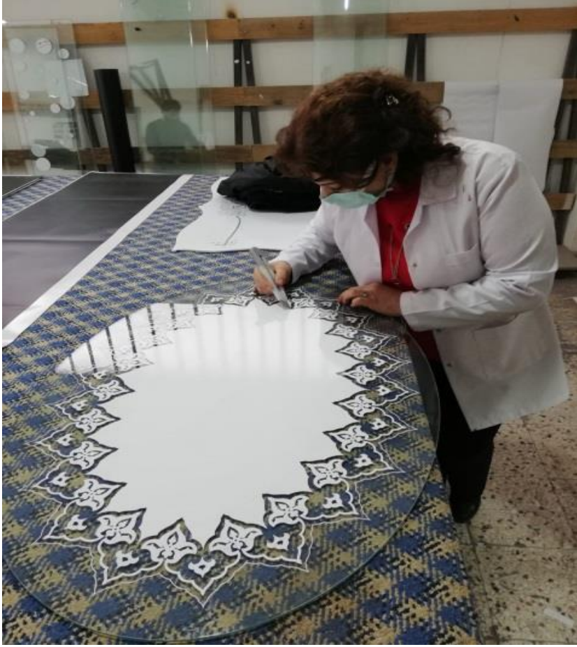
Resim 14. Desenin Folyo Bant Yardımıyla Cama Geçirilmesi ve Koparma Yapılacak Alanların Bantlarının Ayıklanması
