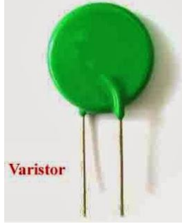
Şekil-6 MOV'un Şekli ve Sembolü
