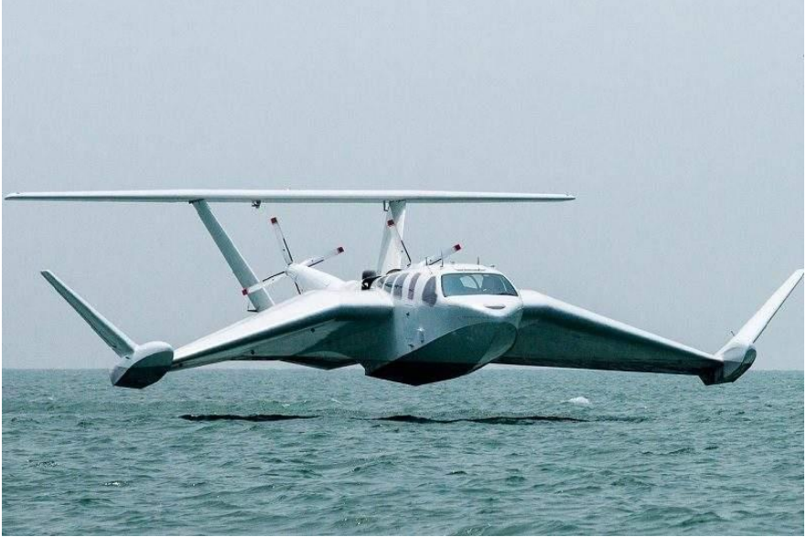
Şekil-2 WIG Yer Etkisindeki Kanat AIRFISH 8 (FS-8. The WIG page. 2008)
