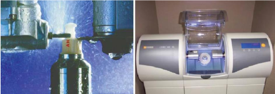
Şekil 14 Hazırlanmış CEREC kronunun frezelenmesi(Babajı 2015)
