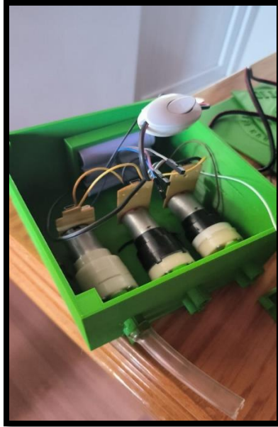
Şekil 4. otomatik dozajlama ünitesi ilk prototip görseli
