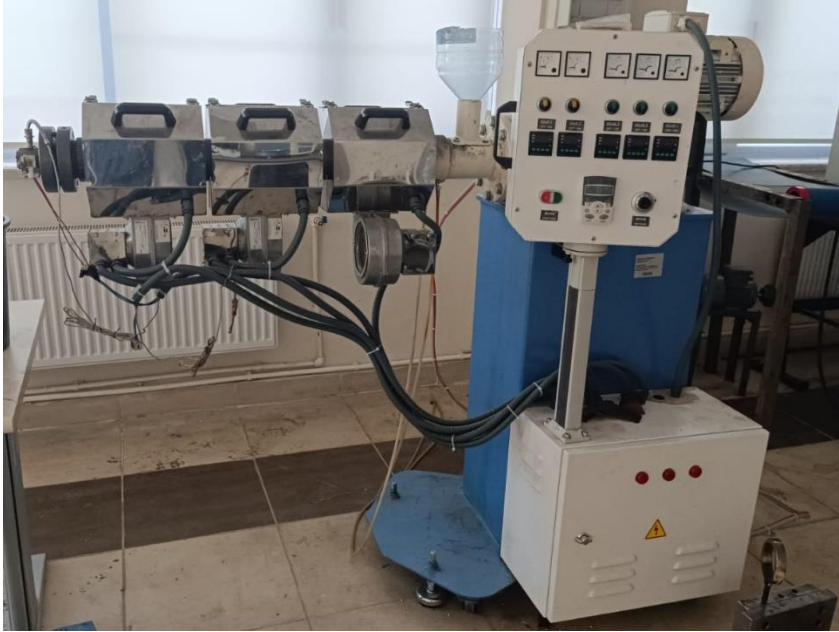
řekil 2: Homojen karışım hazırlamada kullanılan Ekstrüzyon makinası
