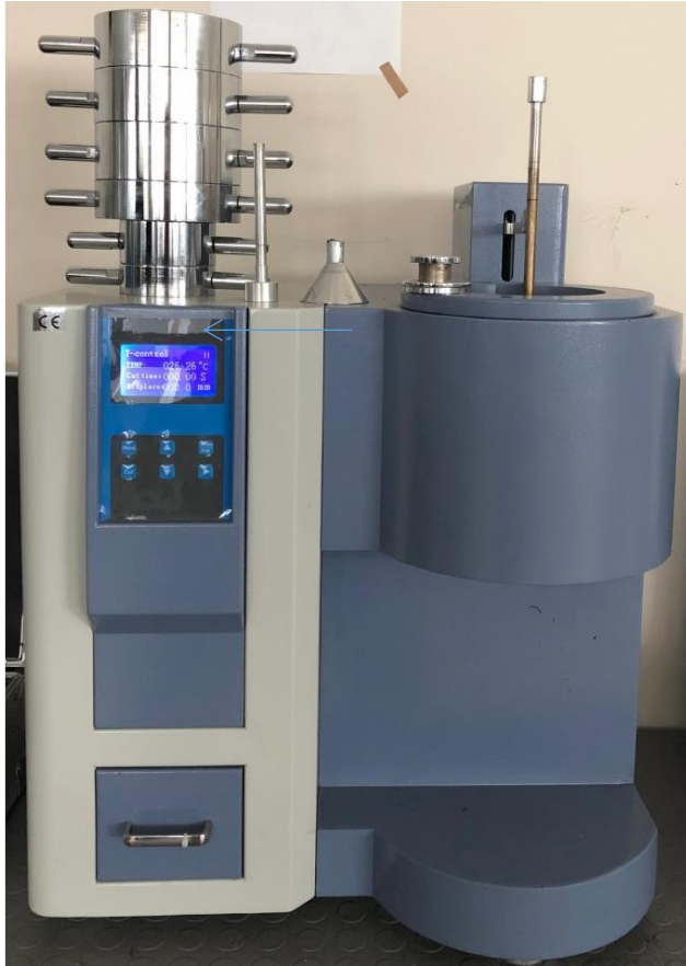
Şekil 1: (MFI) Eriyik Akış İndex Cihazı
