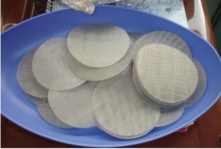
Şekil 13. Paslanmaz çelik tel kafeslerin hazırlanması ve temizlenmesi
