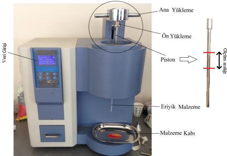
Şekil 1: (MFI) Eriyik Akış İndex Cihazı
