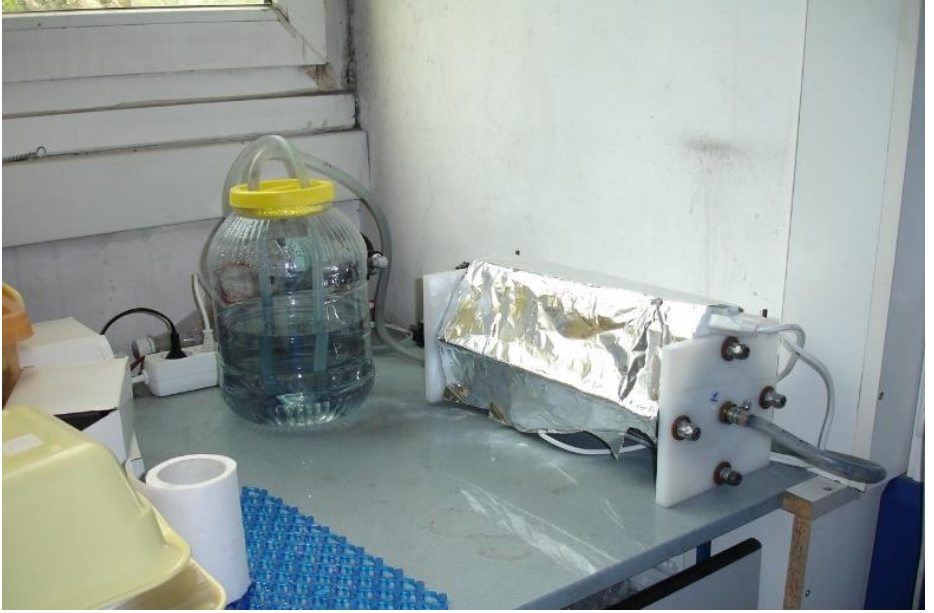
Şekil 31. Metilen mavi tekstil boyası için fotokatalitik uygulama
