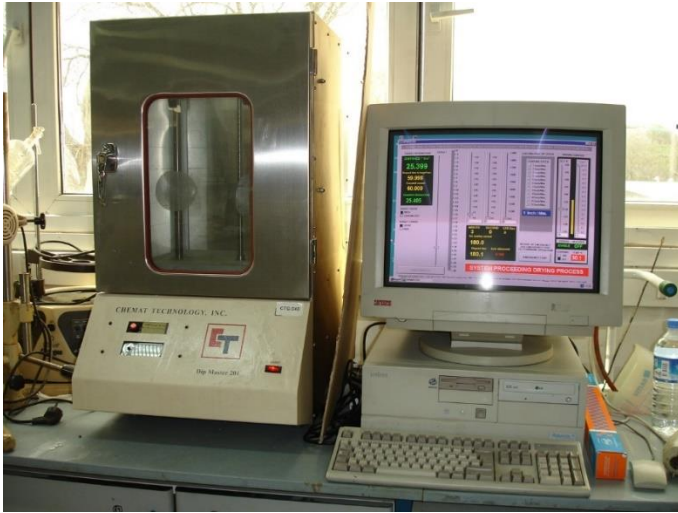
Şekil 15. Chemat Dip Master 201 daldırarak kaplama cihazı
