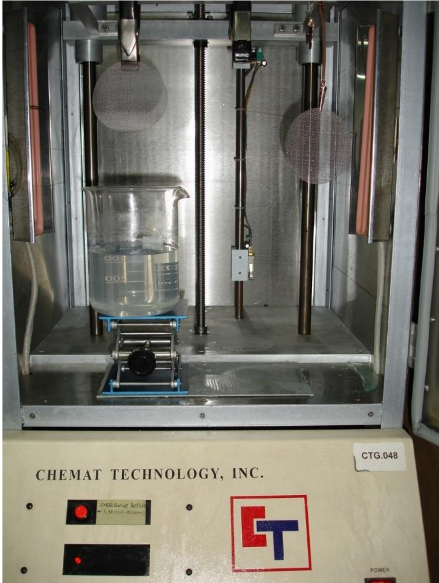
Şekil 16. Paslanmaz çelik tel kafeslerin daldırma yöntemiyle kaplanması
