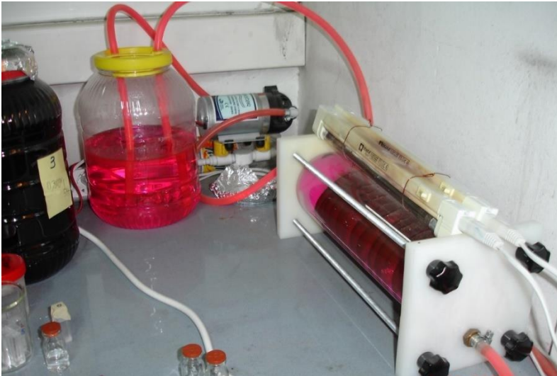
Şekil 28. Alizarin tekstil boyası için fotokatalitik uygulama
