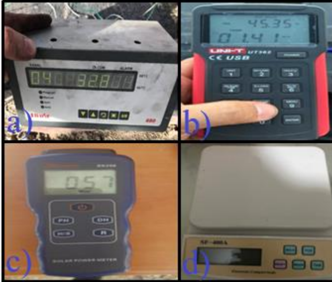
Şekil 4. Ölçüm cihazları; a) Elimko E-680 datalogger b) UNIT UT362 anemometre c) Solar Meter SM206 d) SF 400A hassas tartı
