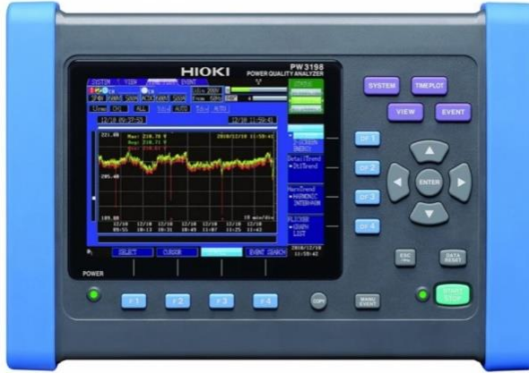
Şekil 3. Enerji tüketiminin belirlenmesinde kullanılan güç analizörü
