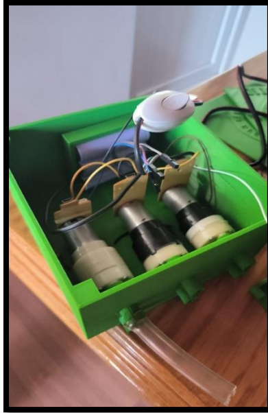
Şekil 4. otomatik dozajlama ünitesi ilk prototip görseli
