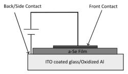
Fig. 6. A planar a-Se alloy detector
