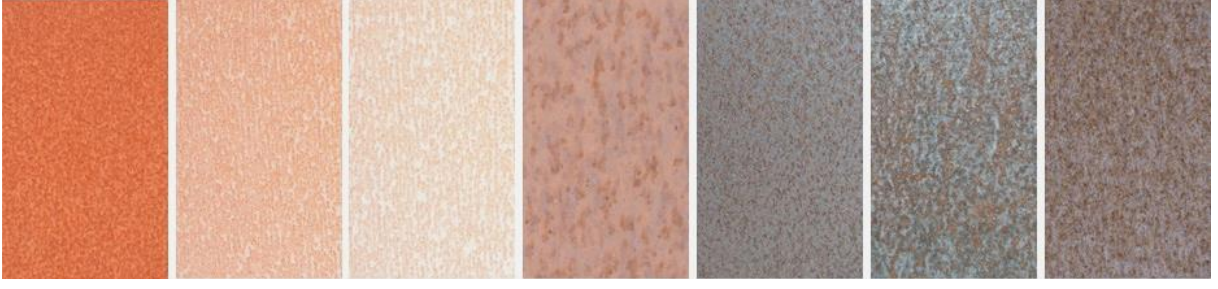
Şekil 3. Yıllara göre farklı maruz kalma koşulları altında gelişen olası oksit tabakası
