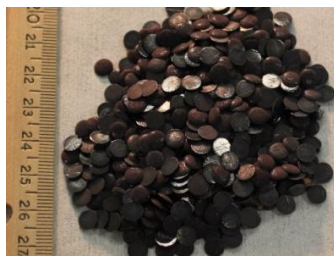
Fig. 4. A-Se alloy pellets (Oner et al., 2015a)
